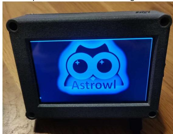
Enfin le logo Astrowl va disparaître et l'image captée par la caméra s'affichera sur toute la surface de l'écran avec un réglage pré défini (par défaut le mode *Starfield*). La caméra n'est pas équipée de lentille, vous ne pourrez pas faire la mise au point. C'est votre instrument astronomique (télescope ou lunette) qui va servir d'objectif et qui permettra de focaliser l'image.
